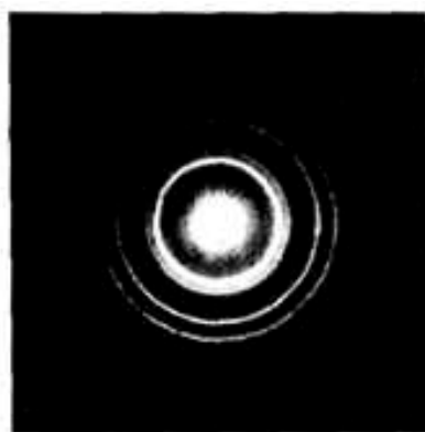
Figure 2.2: 电子束经金属表面衍射的实验观测结果
