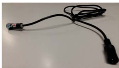
图6 激光二极管，其输出功率为0.5 mW，波长为 650 nm (II类激光)
