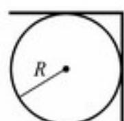
一块板，沿中线折成直角，放置在水平固定的半径为  $R$  的圆柱体上，如图所示。圆柱体和板之间的静摩擦系数需要有多大，才能使板子不滑开？
