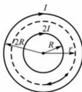
一个长的螺线管包括了另一个同轴的螺线管（它的半径  $R$  是外面螺线管的一半）。它们的线圈单位长度具有相同的圈数，且初始时都没有电流。在同一瞬间，电流开始在两个螺线管中线性增长。在任意时刻，里边的螺线管中的电流为外边螺线管中的两倍，它们的方向相同。由于增长的电流，一个初始静止的处于两个螺线管中间的带电粒子，开始沿着一根圆形的轨道运动（见图）。问圆的半径  $r$  为多少？
