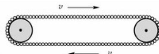
一根可变形的、质量均匀分布的链条被紧紧绕在两个圆柱体上，其形状就像大型运动场的跑道形状一样，即，它由两个直的部分连接两个半圆形的部分而组成。圆柱体可以旋转，并且导致链条以速
