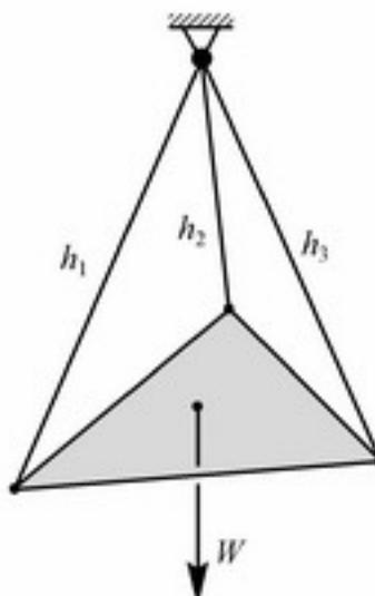
请用细绳的长度、板的重量表示出每根绳子内部的张力。
