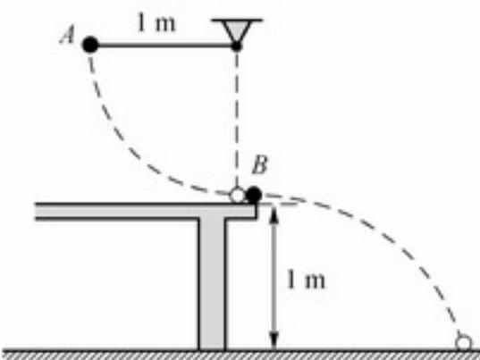
小钢球  $B$  停放在高  $1\text{ m}$  的桌边上，另一个钢球  $A$  作为一个  $1\text{ m}$  长的单摆的摆锤，从单摆悬挂点的平面自由释放，并撞击  $B$  球，如图所示。两个球的质量是相同的，碰撞是完全弹性的。
