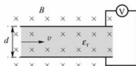
一个初始时未充电的电容的两个极板之间的距离为  $d$ 。有一个磁感应强度为  $B$  的磁场，平行于电容的极板，如图所示。
