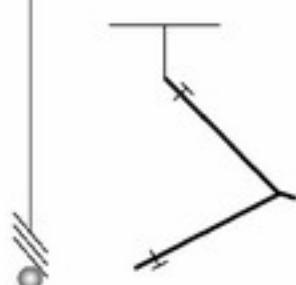
求解如图所示用一根细线悬挂圆规时，圆规张开多大的角度可以使其旋转点抬升得最高，假定圆规两臂的长度相等。
