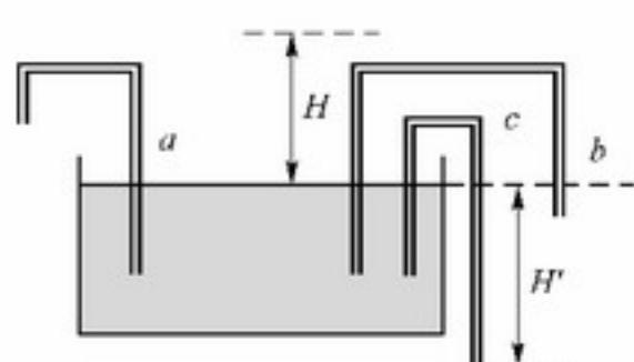
水通过浸润可以在毛细管壁中上升到高度  $H$ 。三个“绞架”形的毛细管  $a$ ,  $b$  和  $c$  使用相同的管子制成，管子的一端放入盛满水的大盘子，如图所示。
