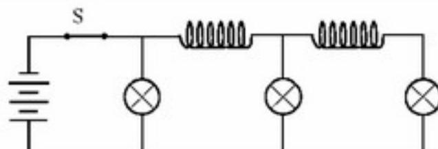
图中所示的电路包括三个相同的灯泡和两个线圈，连接到一个直流电源。线圈的电阻可以忽略。
