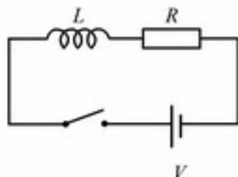
一个电阻和一个电感串联，并通过一个开关连接到一个电池上。
