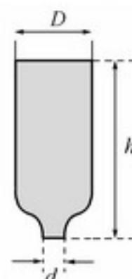
一个顶端开口、直径为  $D$  的玻璃管，其中装满高度为  $h$  的水。玻璃管的底部较狭窄，直径为  $d$ ，被塞子封闭，如图所示。
