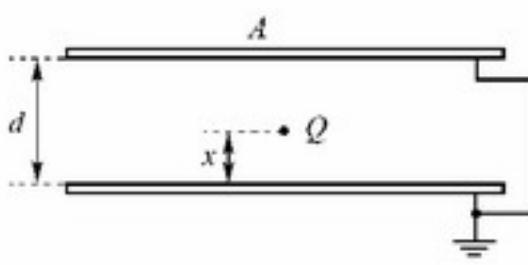
平行板电容器两板间的距离为  $d$ ，每个平板的面积为  $A$ 。如图所示，电容器的两个板都是接地的，在它们之间有一个小物体带电量为  $Q$ ，与其中一个板的距离为  $x$ 。请问每一个板上将会积累多少电荷？
