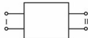
如果电压为  $V$  的电池接在黑箱的 I 端，如图所示，则接在 II 端的伏特计的读数为  $V/2$ 。如果电池接在 II 端，则 I 端的伏特计读数为  $V$ 。已知黑箱中只有无源的电器元件，问它们是什么样子？
