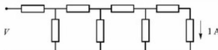
问电阻链的输入端的电压为多少？电阻链的等效电阻是多大？如果再增加一个或两个电阻，等效电阻如何变化？把所得到的结果和“无穷长”链的等效电阻做比较。
