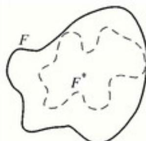
一个封闭体，它的表面  $F$  是由金属箔做成的，相对于“无穷远”其电容为  $C$ 。现在箔表面凹进，新的表面  $F^*$  完全在原表面的内部或者在原表面上，如图所示。
