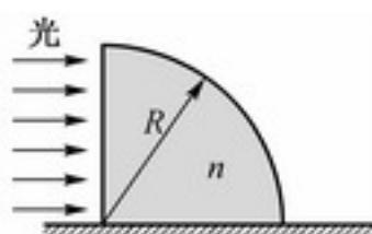
如图为一个四分之一圆柱形的玻璃棱镜，水平放置于桌面上，一束均匀、水平光线入射于其竖直平面。如果圆柱的半径为  $R = 5 \text{ cm}$ ，并且已知玻璃的折射系数为  $n = 1.5$ ，那么光透过棱镜后将在桌面的什么位置形成一个光斑？
