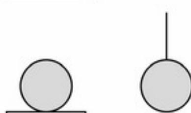
两个相同的铁环，一个立在热绝缘的板上，另一个悬吊在热绝缘的线上。传给两个铁环等量的热能，问哪一个温度高一些？
